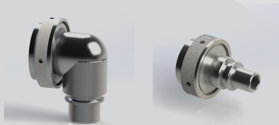
Exemples de raccords type K blindés étanches, pour manchon thermo-rétractable : à gauche, EN3660-062, raccord coudé 90° auto-freiné pour EN3645, à droite, EN3660-064, raccord droit auto-freiné pour EN2997.
